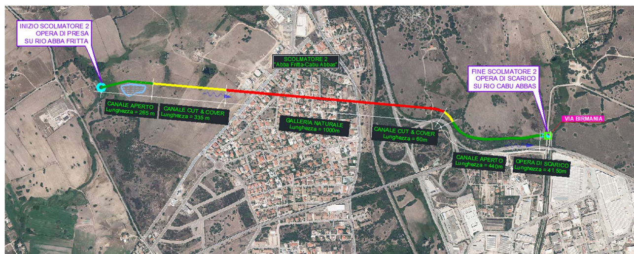
Figura 9.1: Planimetria del canale scolmatore 2 Abba Fritta – Cabu Abbas
